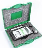
**Feldstärken-Messgerät KD 400 inklusive Tangential-Feldsonde und Tragekoffer.** Das Gerät dient zur Ausmessung des Effektivwertes von Gleich- und Wechselfeldern, Mischformen können in ihren Gleich- und Wechselfeldanteil zerlegt werden.
